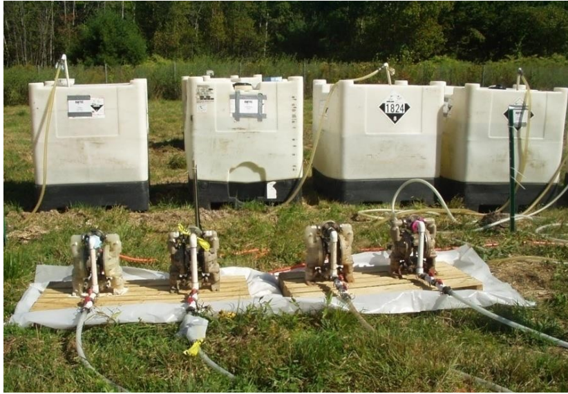
图 5-4 注射井注射药剂示意图
